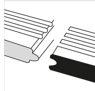
Rainure / languette (têtes de lame)
