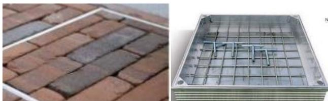
Cadre et couvercle en aluminium extrudé. 2 points de levage et 2 clefs. Hauteur de remplissage : 69 mm. Etanche aux odeurs et eaux de ruissellement. Couvercle muni d'un joint EPDM sur la face de pose et d'un joint caoutchouc sur le rebord, qui empêchent l'encrassement entre le cadre et le couvercle. Couvercle muni d'une armature en treillis soudés. Fond du couvercle en acier galvanisé de 3 mm d'épaisseur.
